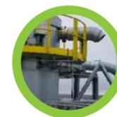
Для защиты атмосферного воздуха от промышленных выбросов пыли полиэтилена, полипропилена установлены рукавные фильтры и циклоны: фильтры гомогенизации гранул, фильтры обеспыливателей гранул, фильтры силосов хранения, системы сбора сдувок.
